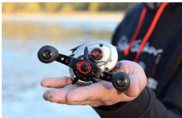
Črn gumb na srebrnem ohišju zgoraj je gumb, ki ustvari trenje ( angl. tension knob). Vidna je tudi zvezdasta zavora; z njo nastavimo, kako močno lahko riba izvleče vrstico.
