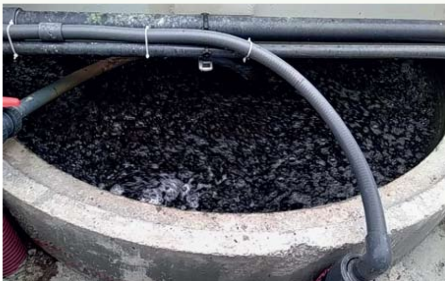
Slika 2: Biofilter tipa MMBR (angl. Moving Bed Bio Reactor) med delovanjem
