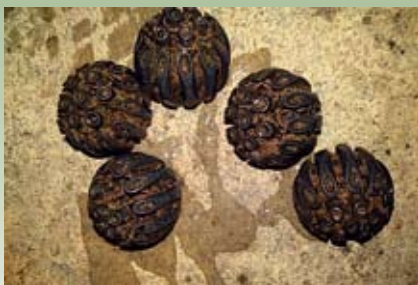
Slika 3: Nosilci bakterij iz statičnega biofiltra pred izpihovanjem. Nosilci bakterij opravljajo hkrati biološko in mehansko filtracijo; mehanski delci se med kroženjem vode ujamejo na površini nosilcev bakterij, potrebno je občasno izpihovanje.
