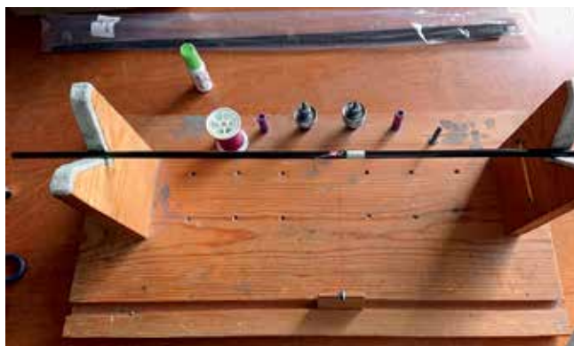
Primer navijanja obročka z orodjem za navijanje
