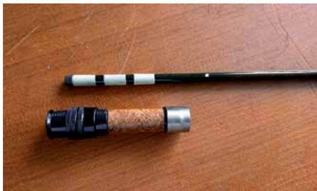
Lepljenje držala kolesca. Pazimo, da je na koncu položaj privitega kolesca na prej določenem »šivu«.
