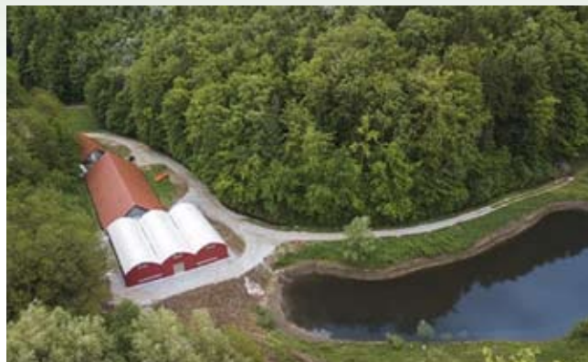
Sistem RAS za vzrejo postrvi, podjetja G2O, d. o. o. Usedlino iz recirkulacije izpuščajo v ribnik za vzrejo mladice krapovcev. Na tak način dosežejo prečiščevanje vode pred vračanjem v vodotok in vzrejo mladice brez dodatnega krmjenja.
