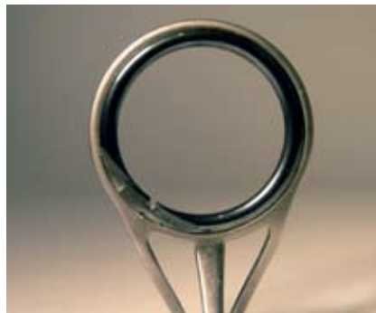
Slika 1: Poškodovana keramika v obročku je kot ostro rezilo in zlahka uniči laks.
