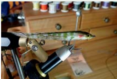
Iz prvega primeža izpred 30 let in več je nastal sodoben in praktičen izdelek, ki vsakemu vezalcu umetnih muh precej olajša delo. V njegove čeljusti lahko vpnemo majhne in velike trnke, zaradi kakovostnega materiala, iz katerega je izdelan, pa bo brez težav služil dolga leta.
