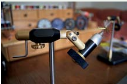
Iz prvega primeža izpred 30 let in več je nastal sodoben in praktičen izdelek, ki vsakemu vezalcu umetnih muh precej olajša delo. V njegove čeljusti lahko vpnemo majhne in velike trnke, zaradi kakovostnega materiala, iz katerega je izdelan, pa bo brez težav služil dolga leta.
