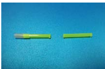
Primer cevke s silikonskim zaključkom in brez njega. Robovi so pripravljene in zaobljeni z vžigalnikom.
