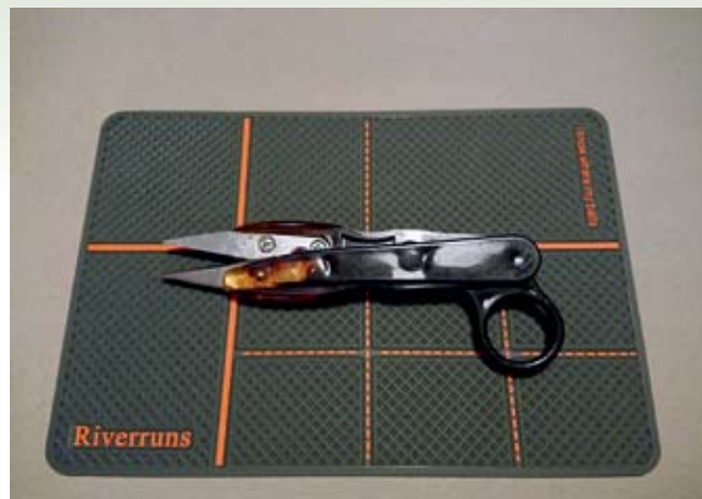
Šiviljske škarjice na vzmet, primerne za delo z »vezalno roko«, najbolje pa je, da jih imamo ves čas vezanja v drugi roki.
